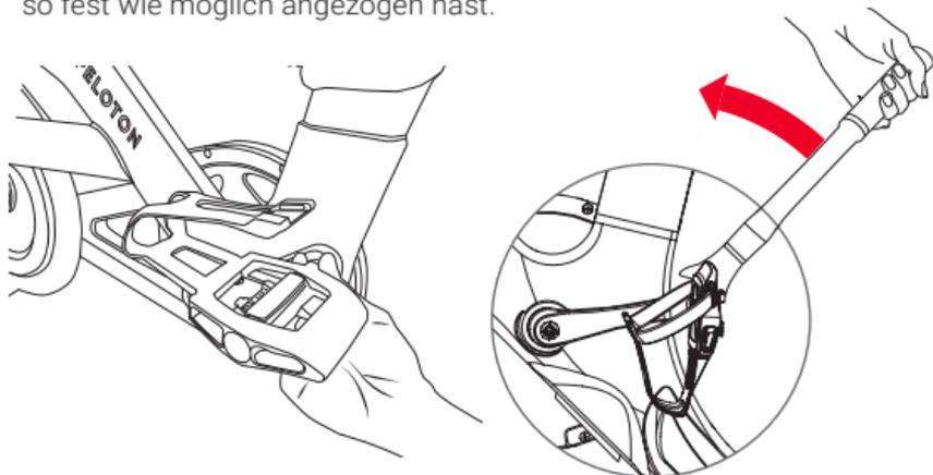
Ziehe die Pedale regelmäßig fest. Denk daran, den Schlüssel auf beiden Seiten in Richtung der Vorderseite des Bikes zu drehen, um die Schrauben anzuziehen.
